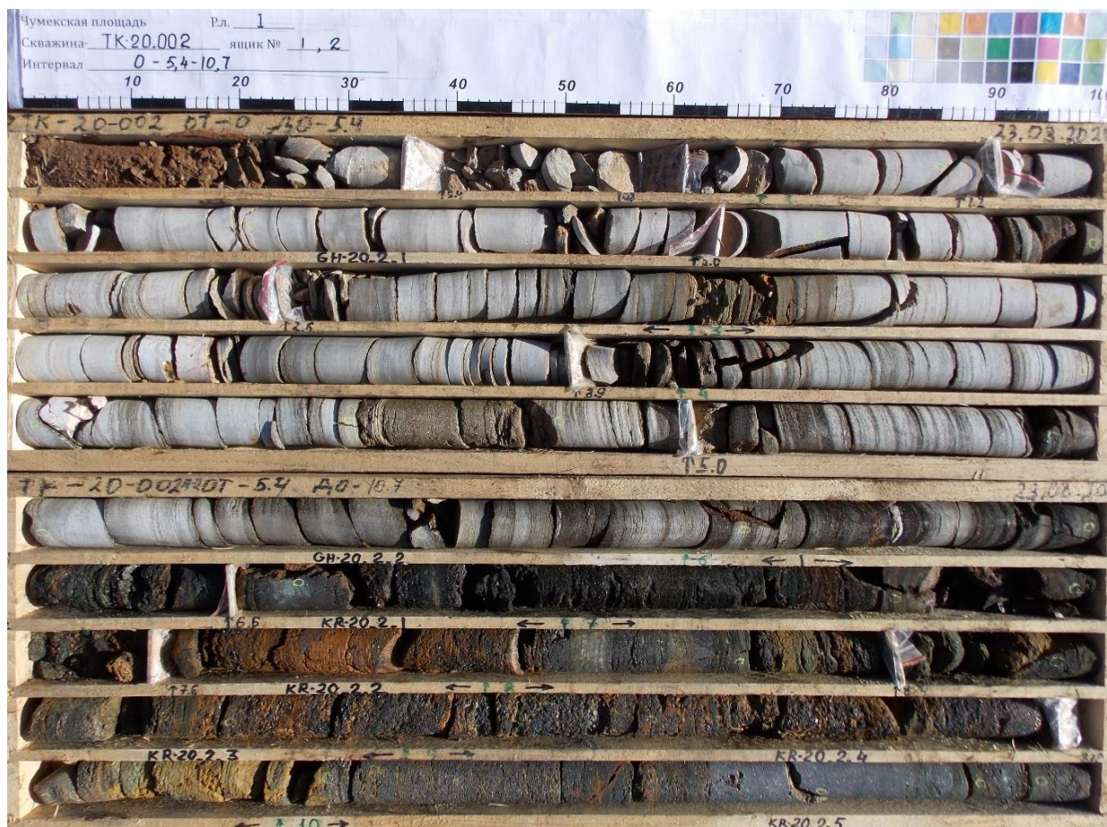
Рисунок 3.4 - Пример фотодокументации керна с железной рудой со скважины ТК_20_002
